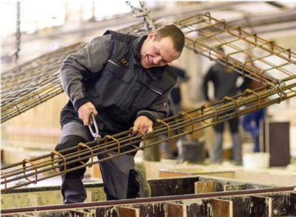
Da ist Kraft gefragt: Stahlbetonbauer Robert Kretzschmar bei der Herstellung von stählernen Bewehrungsmatten für Betonfertigteile im Betonwerk Quast in Coswig.
